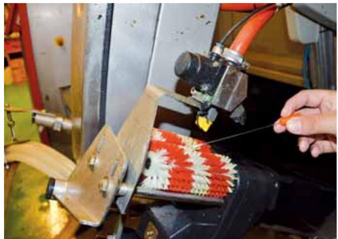
Tupferproben der Eutervorbereitungseinrichtung und Melkbecher wurden bakteriologisch ausgewertet
